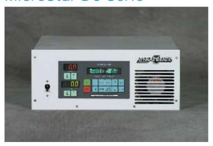
Die auf allen Puls-, periodischen Pulsumkehrungs- und Gleichstromversorgungen standardmäßig erhältlichen MicroStar DC- und MicroStar Puls-Schnittstellen von Dynatronix werden Ihre Galvanisierungsprozesse erleichtern. Die MicroStar-Schnittstelle hat große, leicht lesbare Digitalanzeigen für Ampere und Volt sowie eine dritte Anzeige und ein Soft-Touch-Tastenfeld zur Einstellung und Überwachung zusätzlicher Funktionen.
